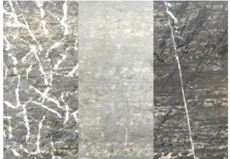
**Abb. 5:** EDELGRAU als Beispiel für die verschiedenen Bearbeitungsphasen des Saalburger Marmors: bruchrauh, geschliffen, poliert (von links nach rechts).
