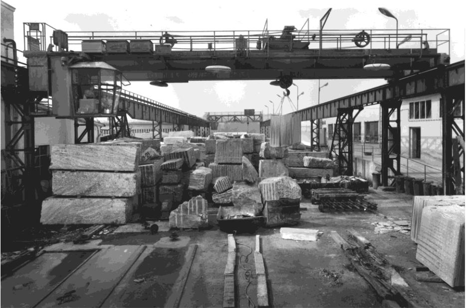
**Abb. 38:** Natursteinblocklager mit 16-Tonnen-Brückenkran.
